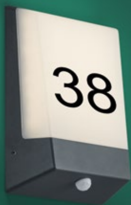
3239659.* Aluguss Anthrazit EEK: A+ 9 W, LED 3000 K, 850 lm H 211, B 161, A 59 mit Dämmerungs- schalter und Hausnummern-Set € 101,80
